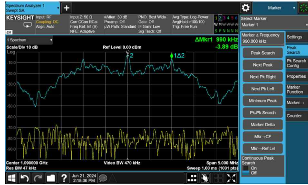
그림 12. PPM 변조로 발생한 peak 지점 Fig. 12. Peak caused by PPM modulation.
