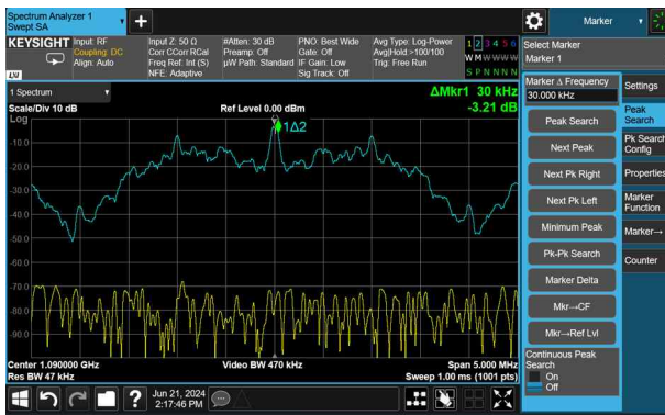
그림 11. Peak에서부터 -3dB 확인지점 Fig. 11. -3dB measured point from the peak.
