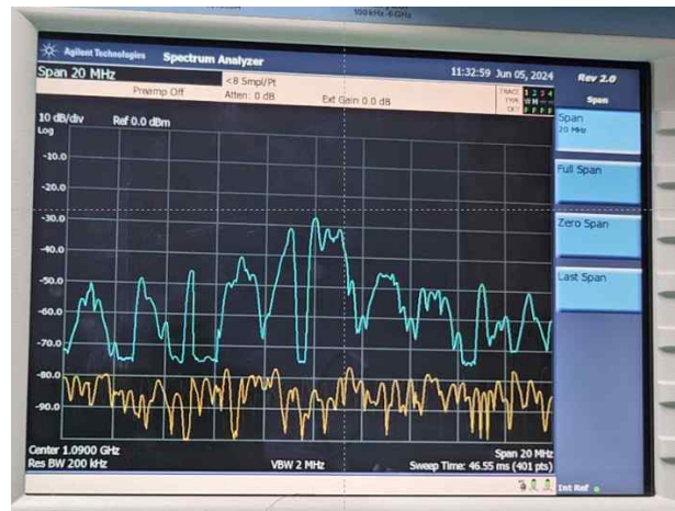
그림 8. N1996A CSA로 측정한 ADS-B out 스펙트럼 Fig. 8. ADS-B out spectrum measured with N1996A CSA.
