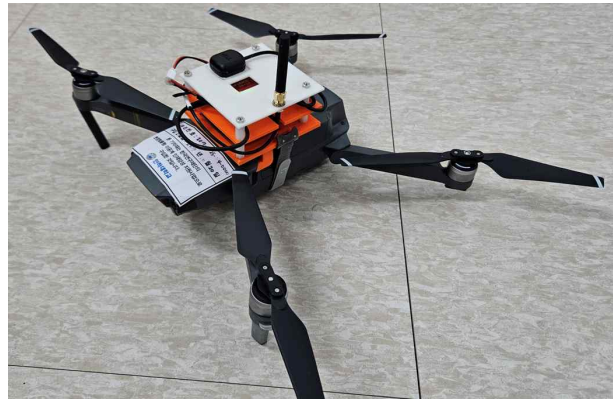
그림 16. DJI 메빅 프로 드론에 부착한 ADS-B 송수신기 Fig. 16. ADS-B transceiver equipped to DJI Mavic pro.
